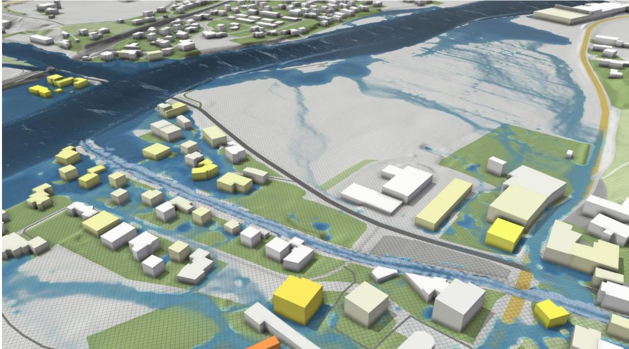
Abb. 2.2.5.1: Das quadratische Simulationsraster mit 2 m ermöglicht eine genaue Auflösung des DGM und der Gebäude und eine exakte Berechnung der Wassertiefen.
