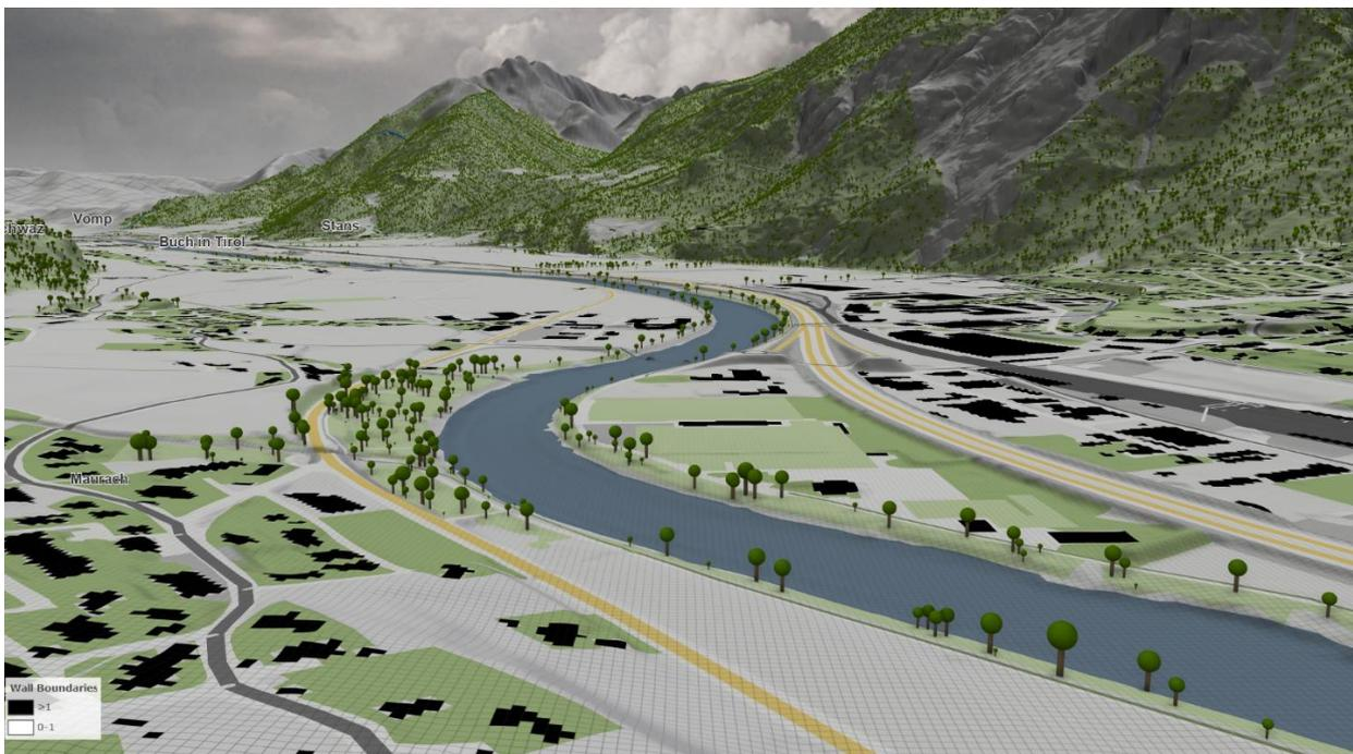
Abb. 2.2.6.3: Gebäude werden in der Simulation als nicht durchlässige Wände modelliert. Betroffene Rechenzellen sind im Bild schwarz eingefärbt.
